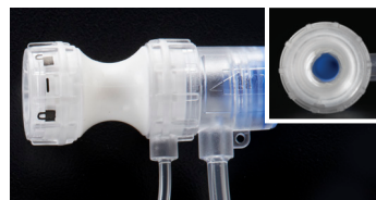
Figura 1. Válvula antes da pressurização
