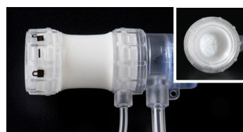
Figura 2. Válvula após a pressurização
