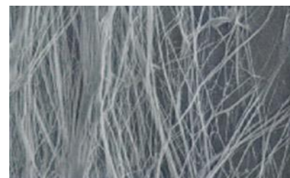
MEB du film de renforcement à grossissement de 1 000 x
